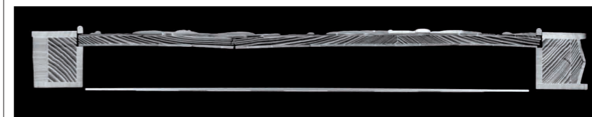
■ Řez chebskou reliéfní intarzií. Díky mikrotomografu se podařilo odhalit i příčinu deformace reliéfní desky.
