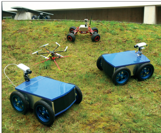
Obr. 1. Do průzkumné skupiny Cassandra lze zařadit roboty různých vlastností, od větších průzkumných robotů RoboKop, přes menší stroje Brontes až po létající multikoptéry
