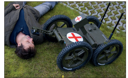
Obr. 2. Vojenský robot Orpheus-AM pro vyhledávání osob a zjištění jejich zdravotního stavu a životních funkcí
